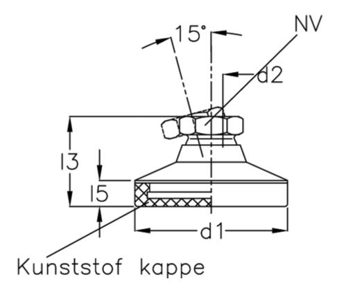
d1 = 32 d2 = 8 l3 = 24.5 l5 = 6.5 NV = 12 Static load (N) = 7 t min = 9
